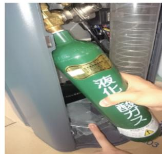
④上の写真のような感じで炭酸ボンベの足元をホールドしているステンレスの輪を指で下に押している間に、一旦ボンベを上スペースに持ち上げて、ボンベの足元から外に出します。
