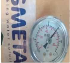
③調整幅は上の写真で黒い方の数値を基準にして2.8~4.2barの間で調整してください。
