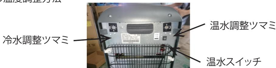
上の写真のように、サーバー背面上部に温冷水の調整つまみと温水のスイッチがついています。右側が温水の調整つまみ及び温水のON/OFFスイッチです。温冷水のつまみとも右に回すほど強く、左に回すほど弱くなります(マイナスイドライバーなどで回してください)。冷水のつまみのミニマムはOFFになります。(※冷水の温度は炭酸の攪拌率に比例しますので冷水温度を弱くすると炭酸力も弱くなります)
